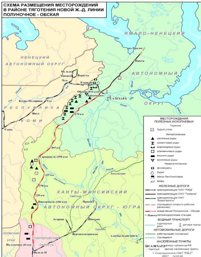
Рис. 3.2. Железнодорожная трасса Полунchnое – Обская как важнейший элемент мегапроекта «Урал Промышленный – Урал Полярный»
